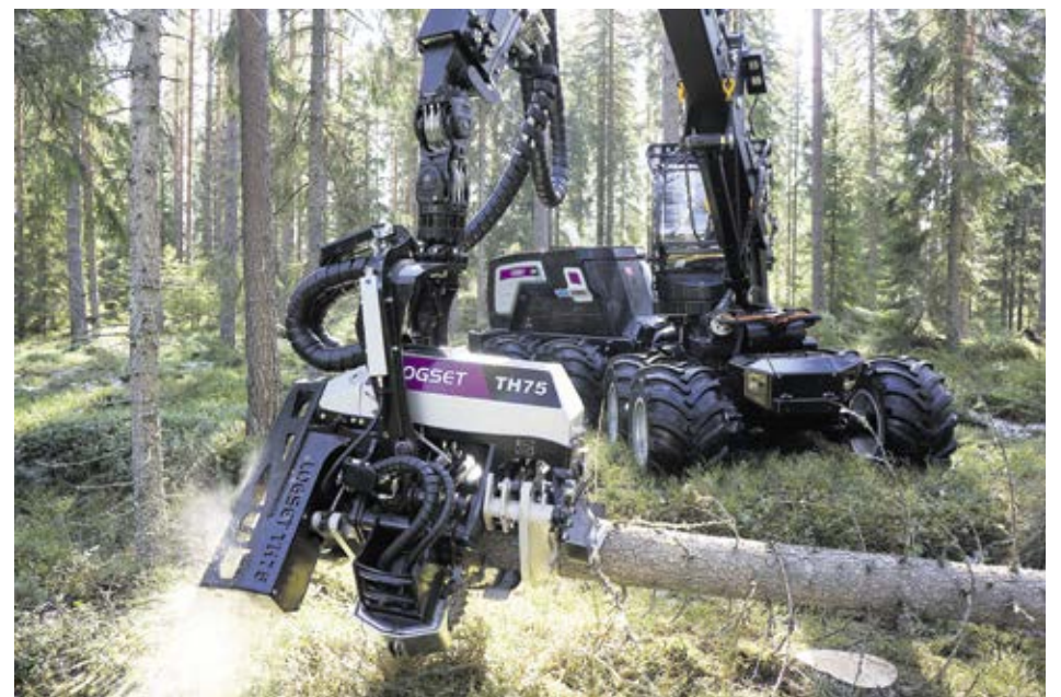
Logsetskördaren 8H GTE Hybrid skördare med ett TH75 aggregat.
